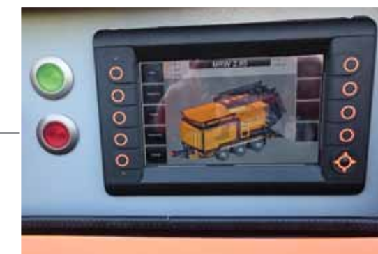
Dotykowy panel sterujący wszystkimi funkcjami maszyny
