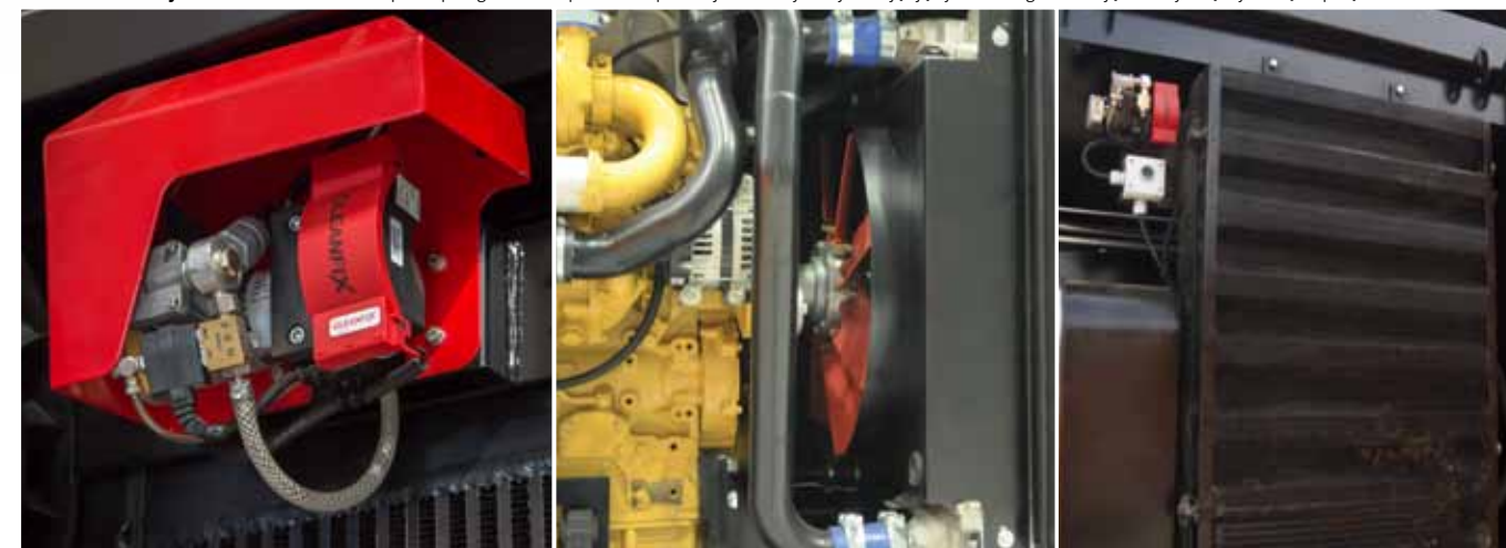
System Cleanfix chroni silnik przed przegrzaniem z powodu zapchanej chłodnicy, oczyszczając ją cyklicznie i gwarantując efektywną wymianę ciepłą
