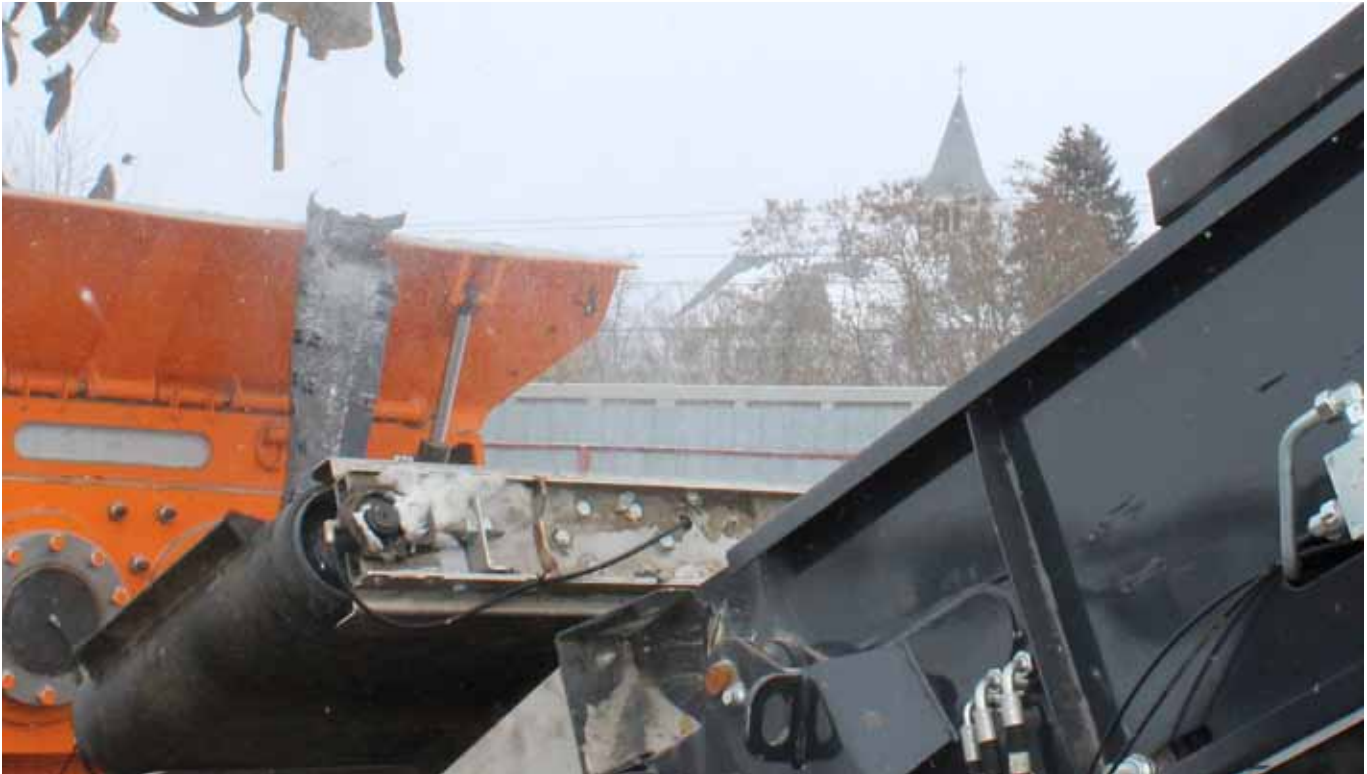
Separator magnetyczny nad przenośnikiem taśmowym
