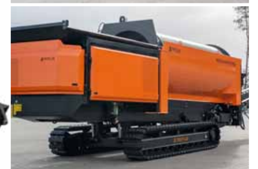
Układ hydraulicznego unoszenia ramy MPB 20.55gh pozwala wyposażyć maszynę do pracy na pochyłościach wzdłużnych i zwiększa prześwit ułatwiając pokonywanie nierównego terenu.
