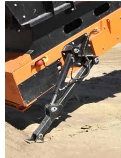
Hydrauliczne podpory (jako opcja) w tylnej części przenośnika
