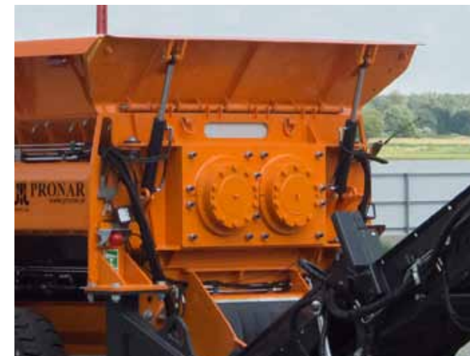
Łatwa do wyjęcia kasetka zaoszczędzająca czas wymiany wałów
