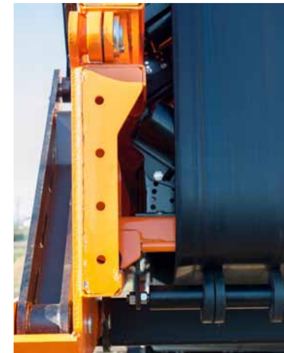
Możliwość zmiany kąta rolek podpierających taśmę w celu uformowania strumienia przenoszonego materiału (zmiana profilu taśmy)
