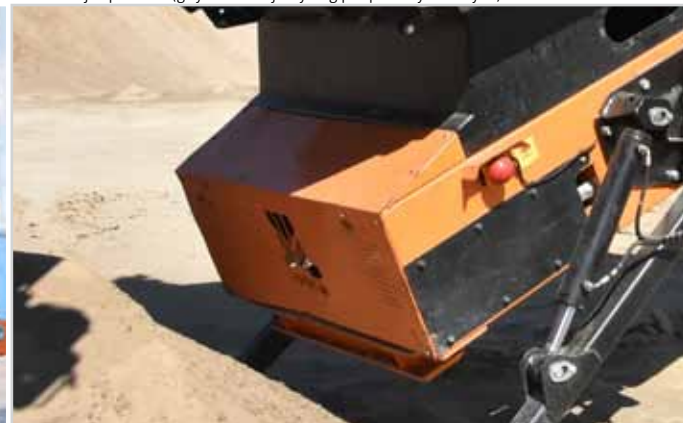
Podpora w tylnej części przenośnika chroni osłony przed uszkodzeniem przy opieraniu konstrukcji o podłoże (gdy nie stosujemy nóg podporowych)
