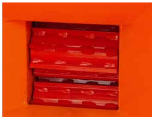
Rolki podające materiał na komplet noży rozdrabniających.
