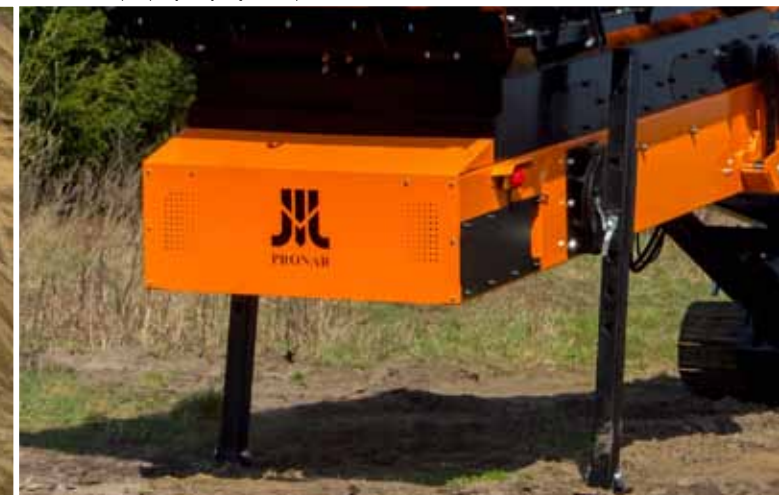
Mechaniczne podpory w tylnej części przenośnika
