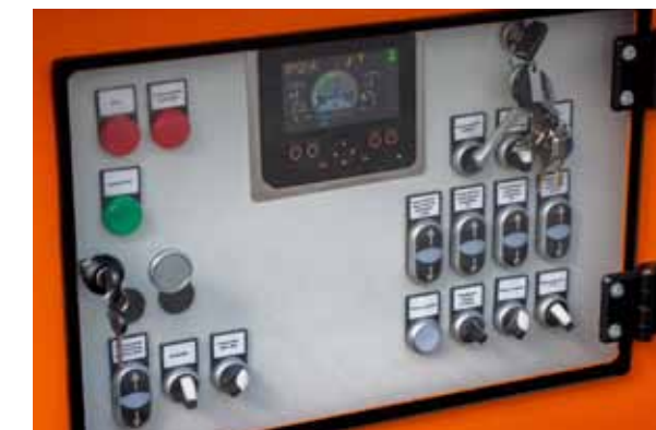
Funkcjonalny pulpit sterowniczy pozwala monitorować i ustawiać parametry pracy przenośnika
