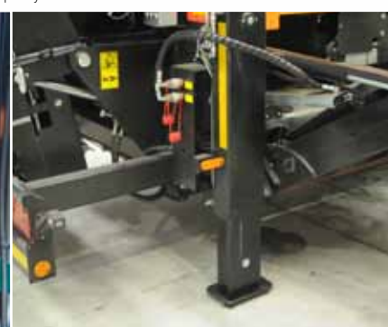
Hydrauliczne stopy podporowe zwiększają komfort pracy operatora oraz zapewniają większą stabilność przesiewacza podczas pracy
