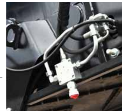
Regulacja prędkości przesuwu taśmy podajnika
