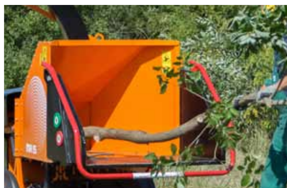
Gałęzie pobierane są samoczynnie za pomocą napędzanych hydraulicznie wałków wprowadzających.
