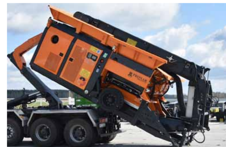
Transport na nośnikach z ramą hakowca
