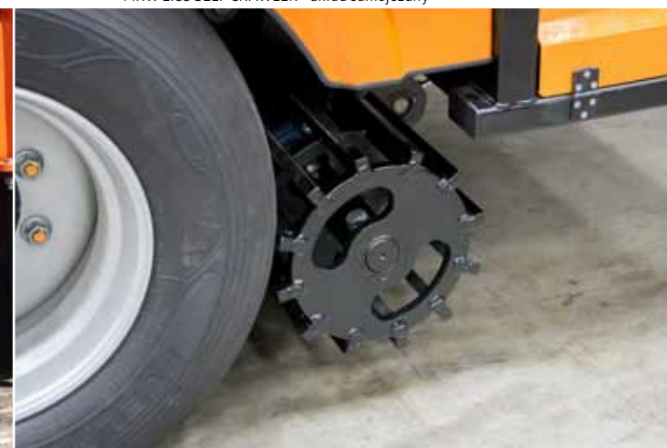
MRW 2.85 SELF CRAWLER - układ samojezdny
