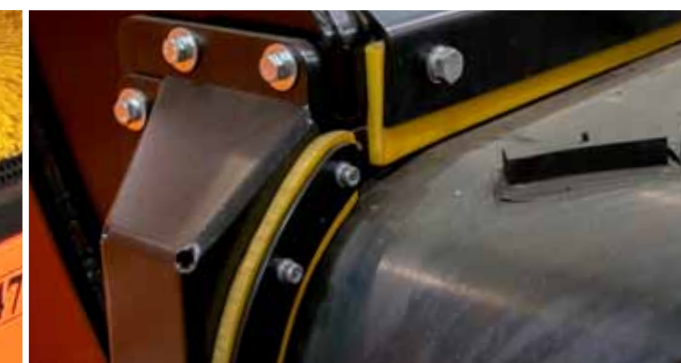
Uszczelnienia w koszu zasypowym chronią przed przedostawianiem się materiału wsadowego do wnętrza maszyny.
