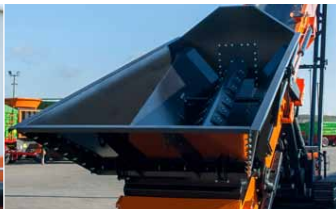
Belka z regulowanymi przepustnicami odciąża taśmę i eliminuje obciążenia dynamiczne podczas załadunku
