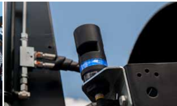
Wielofunkcyjny kogut sygnalizuje tryb pracy (przesiewanie/jazda)
