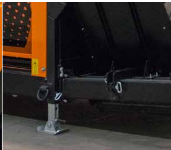
Mechaniczne nogi podporowe przednie zapewniają stabilność przesiewacza podczas pracy
