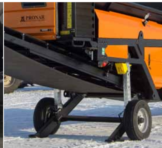
Wahacz podporowy tylny hydrauliczny regulowany do pozycji roboczej lub transportowej
