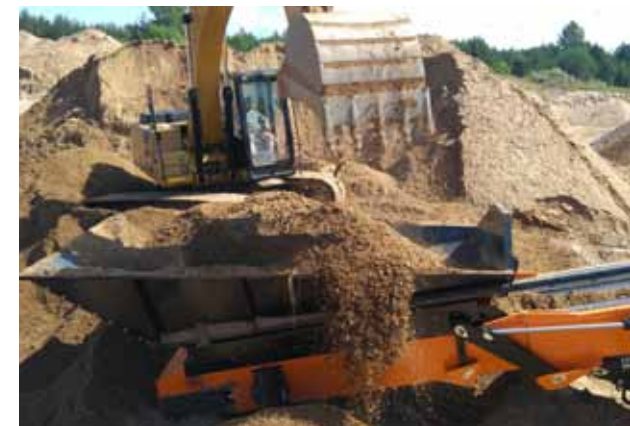
Duża wytrzymałość przenośnika umożliwia zastosowanie kosza zasypowego Direct o poj. 8m 3 bez dodatkowych modyfikacji przenośnika.
