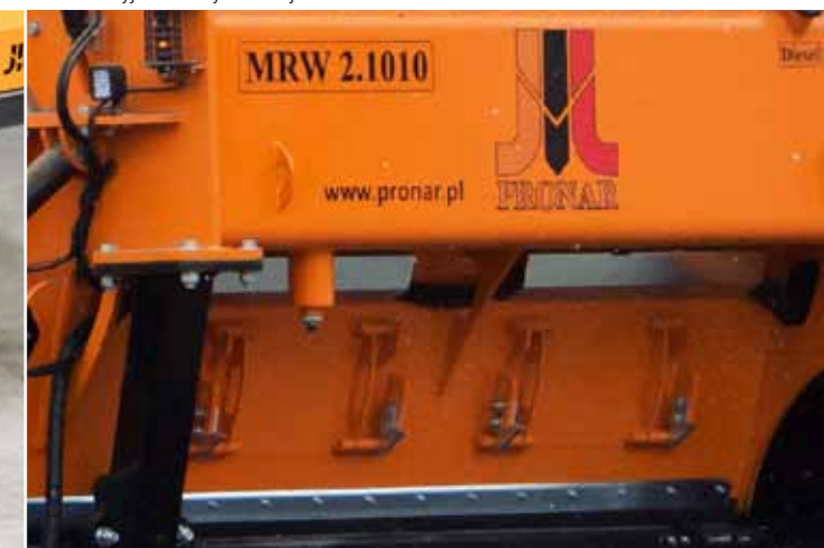
Okna rewizyjne komory roboczej
