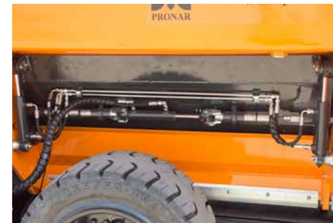
Hydrauliczne ściany boczne do szybkiego ustawienia wielkości frakcji
