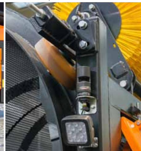
Wielofunkcyjny kogut sygnalizujący tryb pracy Lampa robocza
