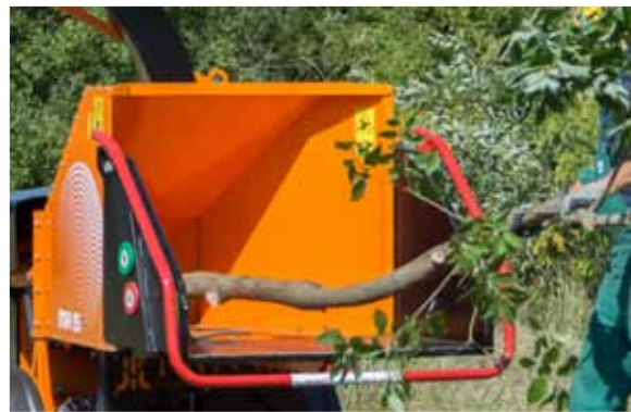
Gałęzie pobierane są samoczynnie za pomocą napędzanych hydraulicznie wałków wprowadzających.
