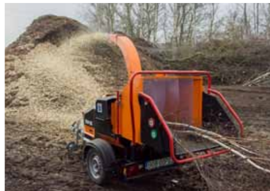
Rampa załadowcza i pałąk bezpieczeństwa
