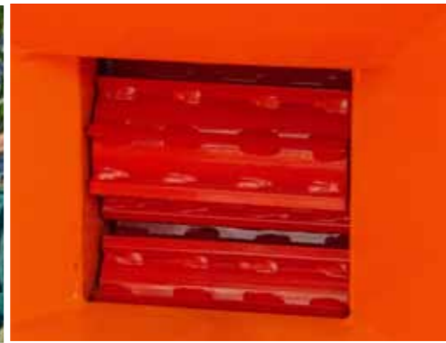
Rolki podające materiał na komplet noży rozdrabniających.
