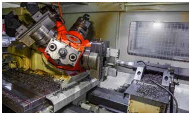
▲ Obróbka czopów osi na centrum CNC
